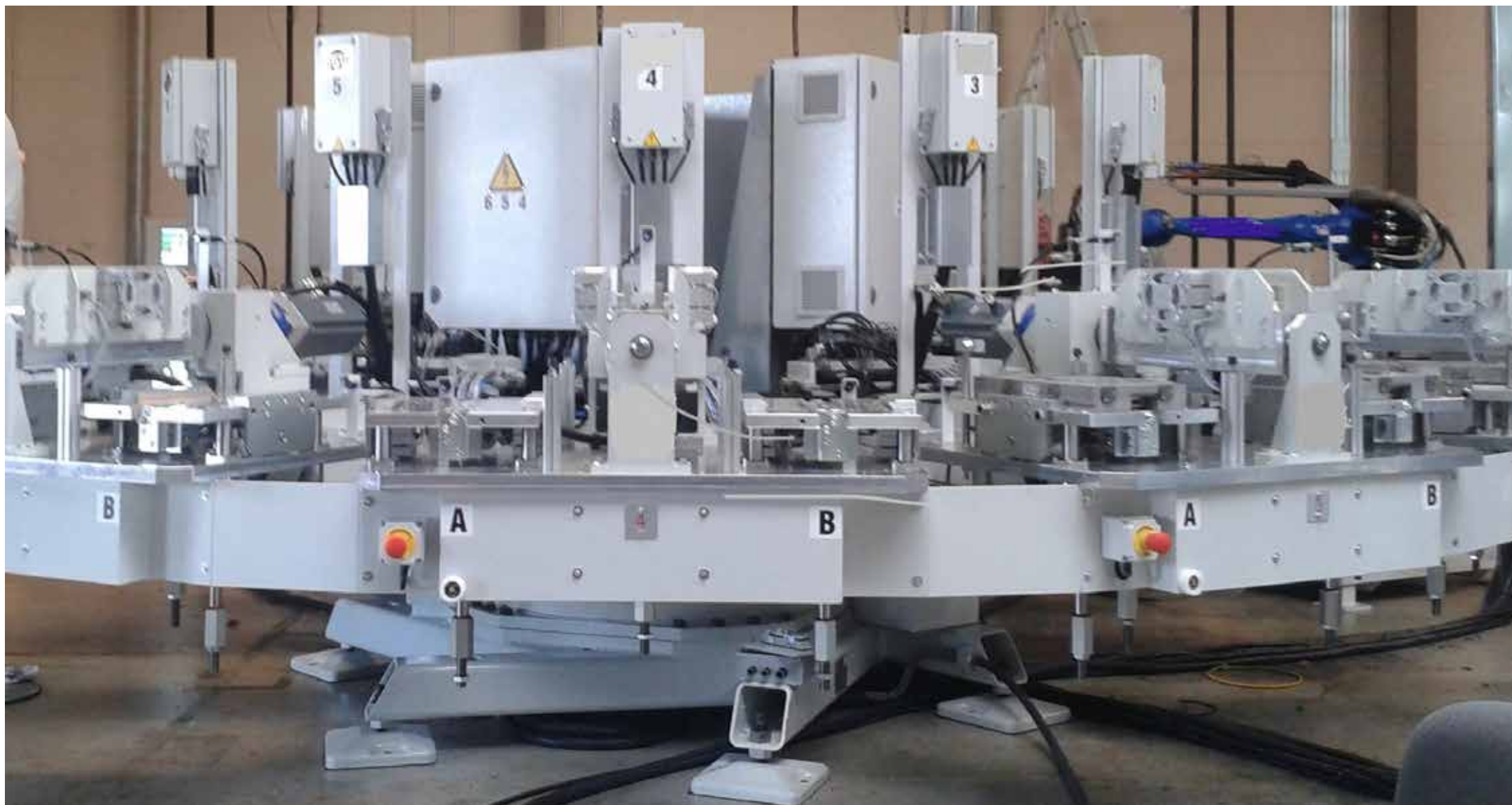
Utilizzo tavola rotante a passo variabile per macchina stampaggio poliuretano.
