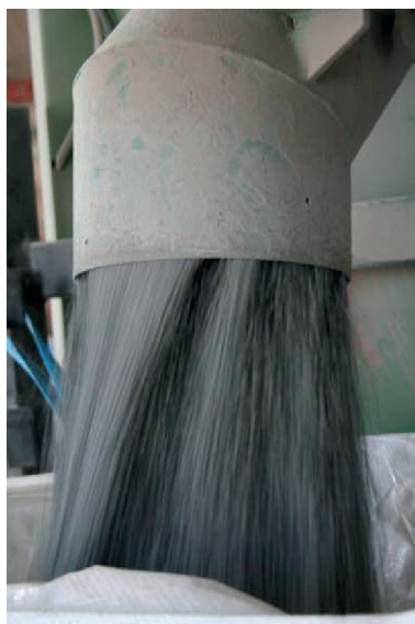
Scarico del PVC rigranulato dal silos miscelatore al Big Bag, pronto per uso interno o per la vendita.
