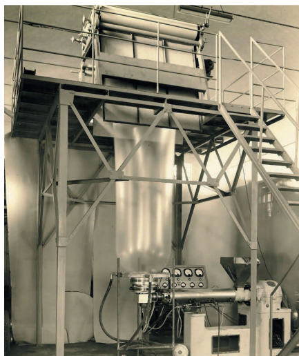
Uno dei primi impianti di film in bolla (foto concessa da Costruzioni Meccaniche Luigi Bandera).
